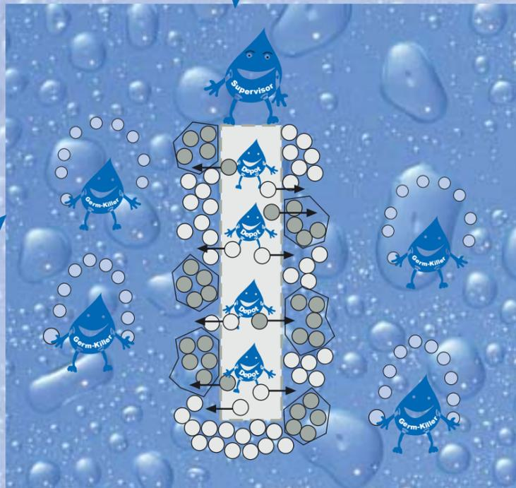
Die von der Oberfläche abgegebenen Silberionen werden aus dem Depot im Inneren wieder aufgefüllt. Die Oberfläche ist daher immer wie neu. Durch dieses – quasi unerschöpfliche – Reservoir wird die langanhaltende sichere Wirkung des Ionic Silver Stick erreicht.
